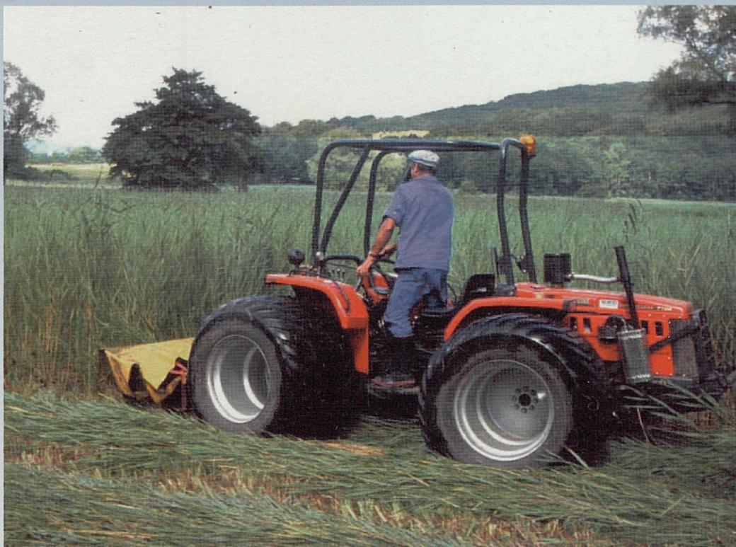
Ein speziell im Rahmen eines LIFE-Natur Projektes entwickelter Traktor, der die Schäden am Niedermoor bei der Schilfernte möglichst gering halten soll. Savoyen, Frankreich.
